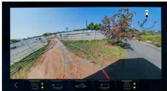
**Vue arrière de la remorque** Une caméra accessoire livrable en option montre les objets derrière une remorque compatible. L'indicateur d'angle de la remorque<sup>1</sup> avec les lignes de guidage<sup>1</sup> montre votre trajectoire. Un deuxième jeu de lignes de guidage indique son trajet selon les mouvements de la direction.
