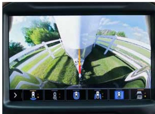
**Vue de caméra arrière** Affiche une vue arrière du camion avec des lignes de guidage disponibles pour vous aider à stationner et à effectuer des manœuvres serrées ou pour atteler une remorque.
