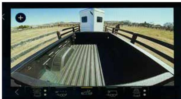
**Vue de caisse** Permet de voir la caisse pour faciliter l'accrochage de la sellette d'attelage ou de l'attelage en col de cygne ou pour brièvement surveiller le chargement.
