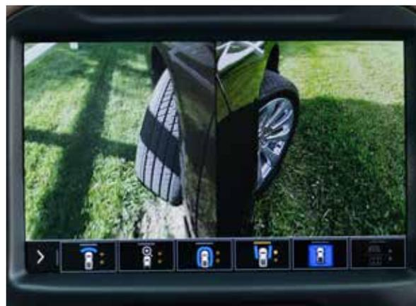
**Vue latérale avant** Affiche la position des pneus avant pendant le stationnement et les manœuvres serrées.
