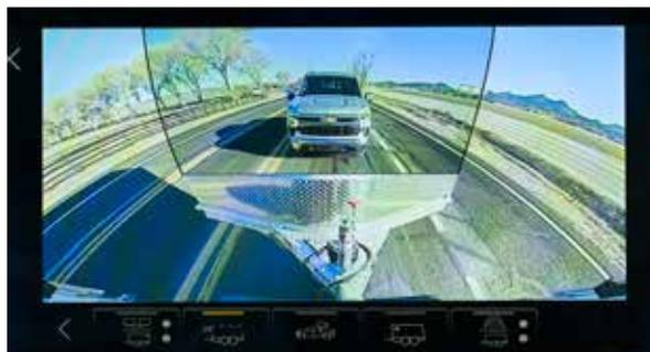
**Vue transparente de la remorque<sup>1</sup>** Permet au conducteur de « voir à travers » une remorque compatible.
