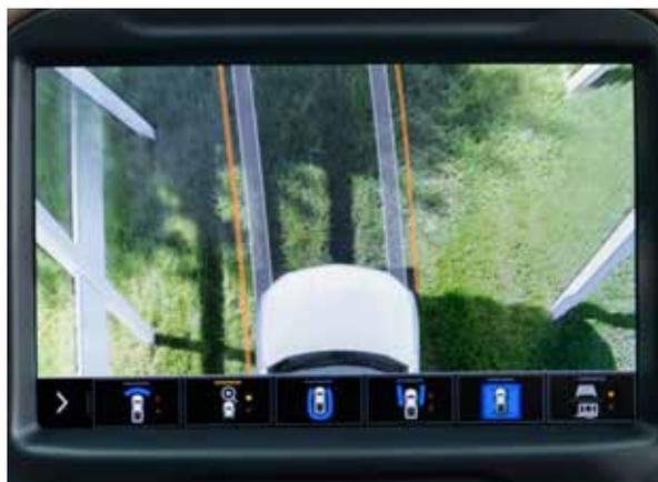
**Vue d'en haut** Vue d'en haut du capot, du pare-chocs et des pneus avant pour les manœuvres serrées dans les stationnements ou le long des trottoirs. Comprend des lignes de guidage qui peuvent être activées ou désactivées selon les besoins.
