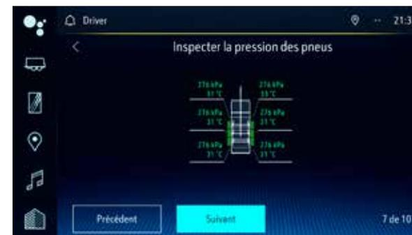
**Surveillance de la pression et de la température des pneus de la remorque<sup>2</sup>** Cette fonction livrable en option vérifie la pression et la température de l'air à l'intérieur d'un maximum de six pneus de remorque pour aider à détecter les éclats potentiels.
