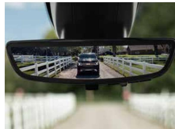
**Rétroviseur à caméra arrière** Un rétroviseur double fonction avec caméra livrable en option qui offre un champ de vision plus large et moins obstrué que celui d'un rétroviseur classique.
