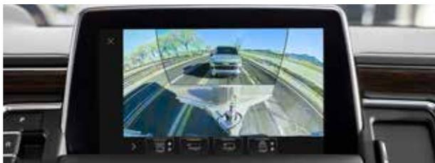
**Vue transparente de la remorque<sup>2</sup>** Permet au conducteur de « voir à travers » une remorque compatible.
