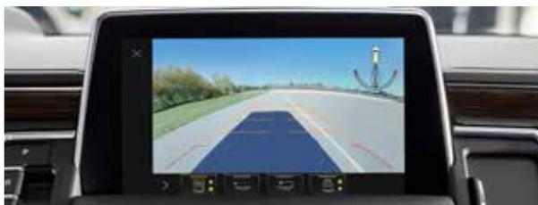
**Vue arrière de la remorque<sup>2</sup>** Une caméra accessoire livrable montre les objets derrière une remorque compatible. L'indicateur d'angle de la remorque<sup>1</sup> avec les lignes de guidage<sup>1</sup> montre votre trajectoire actuelle. Un deuxième ensemble de lignes de guidage indique son trajet selon les mouvements de la direction.
