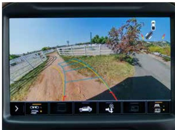
**Vue arrière de la remorque<sup>1</sup>** Une caméra accessoire livrable en option montre les objets derrière une remorque compatible. L'indicateur d'angle de la remorque<sup>2</sup> avec les lignes de guidage<sup>1</sup> montre votre trajectoire. Un deuxième jeu de lignes de guidage indique son trajet selon les mouvements de la direction.
