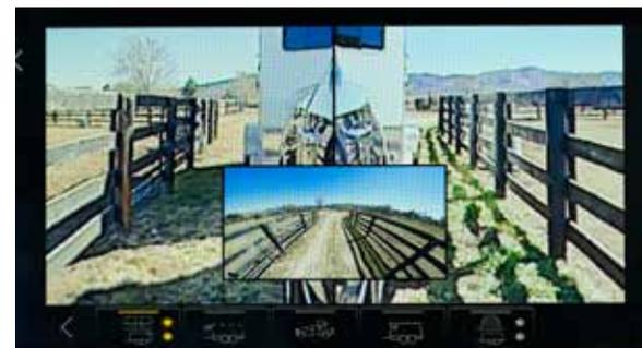
**Vue latérale image à image<sup>1</sup>** Combine deux vues – la vue latérale arrière et la vue arrière de la remorque. Nécessite la caméra Accessoires Chevrolet livrable en option.
