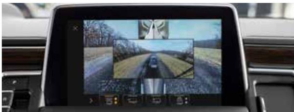
**Vue latérale image à image<sup>2</sup>** Combine deux vues : la vue latérale arrière et la vue arrière de la remorque. Nécessite la caméra Accessoires Chevrolet livrable en option.
