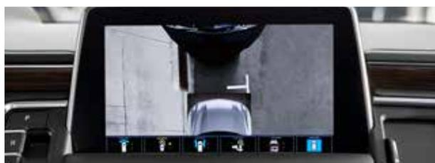
**Vue d'en haut** Vue d'en haut du capot, du pare-chocs et des pneus avant pour les manœuvres serrées dans les stationnements ou le long des trottoirs.
