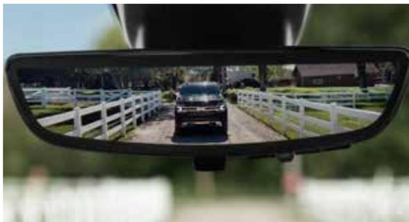
**Rétroviseur à caméra arrière** Un rétroviseur double fonction avec caméra livrable en option qui offre un champ de vision plus large et moins obstrué que celui d'un rétroviseur classique.
