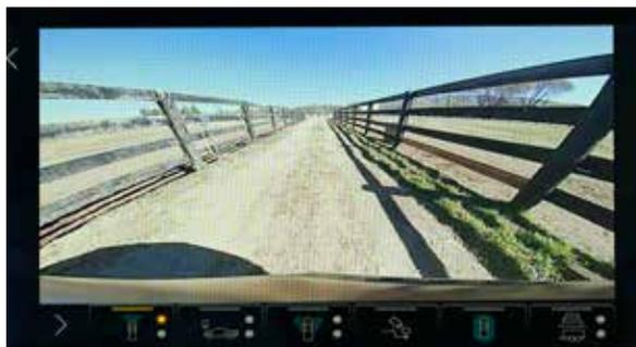
**Vue de la caméra avant** Affiche une vue à l'avant du camion avec des lignes de guidage livrables en option pour aider au stationnement et aux manœuvres serrées.
