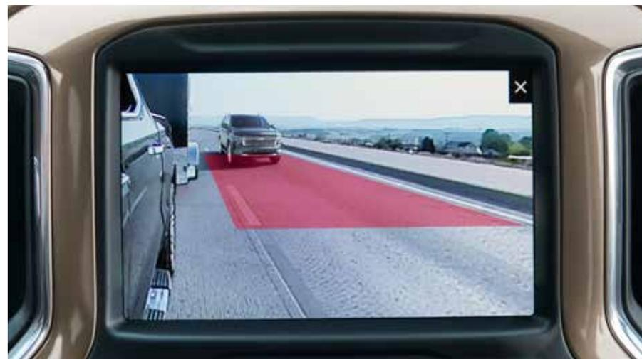
**Vue latérale arrière (activée par le clignotant)** Lorsqu'une remorque compatible est attachée et que le clignotant est activé, cette vue affiche un écran complet sur le côté du camion ainsi qu'un indicateur de longueur de remorque pour faciliter les manœuvres de changement de voie en montrant visuellement les obstructions avec la remorque dans les voies adjacentes.
