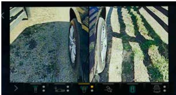
**Vue latérale avant** Affiche la position des pneus avant pendant le stationnement et les manœuvres serrées.
