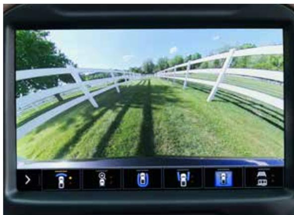
**Vue de la caméra avant** Affiche une vue à l'avant du camion avec des lignes de guidage livrables en option pour aider au stationnement et aux manœuvres serrées.
