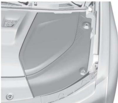
2. Le déverrouillage du cordon de charge manuel d'urgence se trouve sous les couvercles d'accès au capot. Pour le retirer, voir *Couvercles d'accès sous le capot* ⇨ 303.
