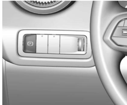
Le frein de stationnement électrique (EPB) peut toujours être serré, même si le contact du véhicule est coupé. En cas de puissance électrique insuffisante, l'EPB ne peut pas être ni appliqué ni relâché. Pour éviter d'épuiser la batterie, éviter les cycles répétés inutiles d'actionnement de l'EPB.
