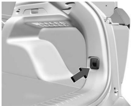
Le compartiment arrière du véhicule est pourvu de deux œillets d'arrimage de chargement. Ouvrir le couvercle pour y accéder.
