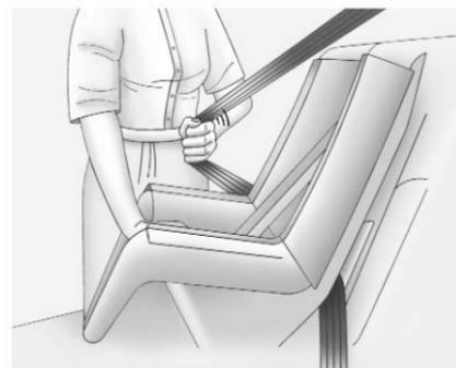
4. Tirer complètement la ceinture épaulière de l'enrouleur pour engager le système de blocage. Lorsque le verrou de l'enrouleur est activé, la ceinture peut être serrée mais pas tirée hors de l'enrouleur.
