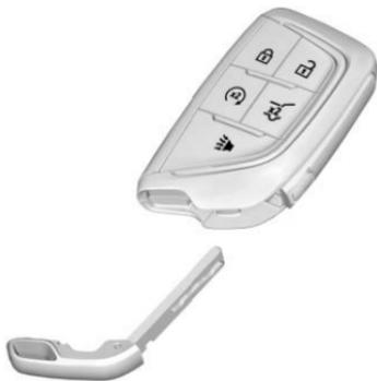
Pour retirer la clé mécanique, appuyer sur le bouton situé près du bas de la télécommande, et tirer sur la clé pour la sortir. Ne jamais retirer la clé mécanique sans appuyer sur le bouton.
