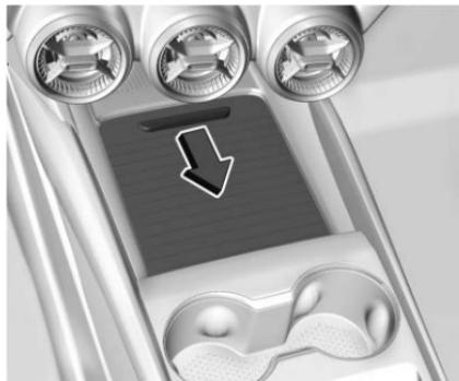
Pour ouvrir le compartiment de rangement avant, faire coulisser le couvercle vers l'avant. Deux ports USB sont se trouvent à l'intérieur. Pour le refermer, pousser le couvercle vers l'avant et lâcher prise.
