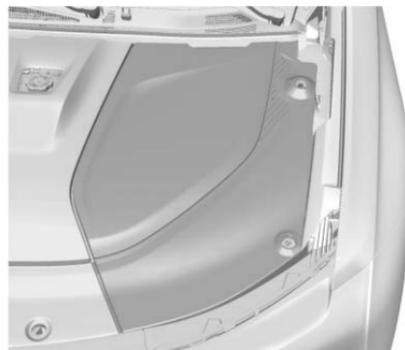
3. Le réservoir de liquide de refroidissement se trouve sous les couvercles d'accès sous le capot. Pour le déposer, voir *Couvercles d'accès sous le capot* ⇨ 303.
