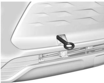
2. Insérer l'œillet de remorquage dans la douille et le faire tourner jusqu'à ce qu'il soit complètement serré. Quand l'œillet de remorquage est déposé, réinstaller le couvercle avec l'encoche dans la position d'origine.
