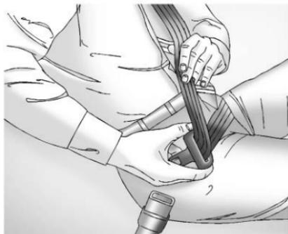
Si la sonde se bloque dans la plaque de verrouillage avant d'atteindre la boucle, incliner le méplat de la plaque de verrouillage pour le déverrouillage.
