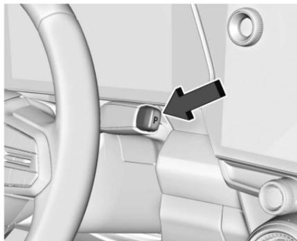
**P** : Cette position verrouille les roues motrices. Engager la position P (stationnement) au démarrage du véhicule pour s'assurer que le véhicule ne bouge pas.
