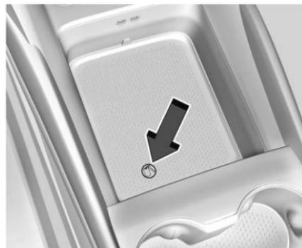
1. Placer la clé télécommande dans le bac de rangement avant avec les boutons orientés vers le bas.
