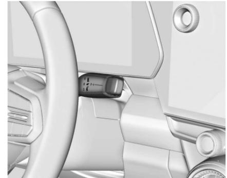
Le véhicule utilise une unité d'entraînement électrique. La grille de rapports de vitesses est affichée sur le devant du levier de vitesses. La position du rapport sélectionné s'éclaire en rouge sur le levier de vitesses, tandis que les autres rapports restent éclairés en blanc. Si le changement de rapport ne s'effectue pas immédiatement, par temps très froid par exemple, le témoin lumineux du changement de vitesse peut clignoter jusqu'à ce que le rapport soit complètement engagé.
