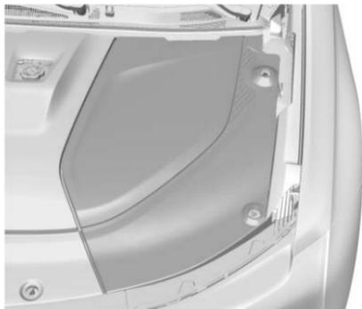
5. La borne positive (+) de la batterie et le point de mise à la masse négatif (-) se trouvent sous les couvercles d'accès au capot. Pour les retirer, voir *Couvercles d'accès sous le capot* ⇨ 303.
