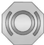
Le réservoir de maître-cylindre de frein est rempli de liquide pour frein DOT 4 homologué par GM, comme indiqué sur le bouchon du réservoir. Se reporter à *Aperçu du compartiment sous capot* ⇨ 305 pour connaître l'emplacement du réservoir.
