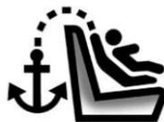
Pour vous aider à repérer les ancrages d'attache supérieure, le symbole d'ancrage d'attache supérieure se trouve près des ancrages.
