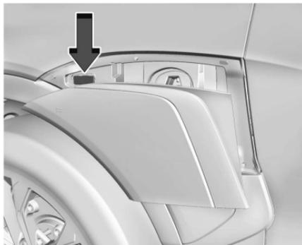
2. Appuyer sur le bouton pour fermer manuellement le volet de la borne de charge.
