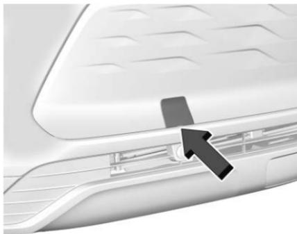
1. Ouvrir soigneusement le couvercle sur le bouclier à l'aide de la petite encoche qui dissimule la prise de remorquage.
