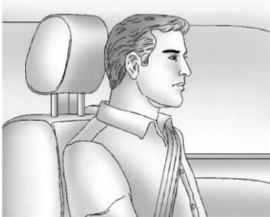
Régler l'appui-tête de sorte que sa partie supérieure arrive au niveau du haut de la tête de l'occupant. Cette position réduit les risques de blessure à la nuque lors d'une collision.
