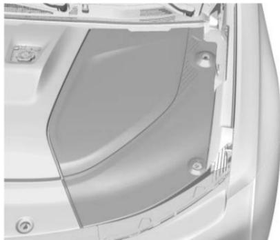
2. Le bloc-fusibles du compartiment sous le capot se trouve sous les couvercles d'accès sous le capot. Pour le déposer, voir *Couvercles d'accès sous le capot* ⇨ 303.
