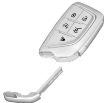
1. Appuyer sur le bouton sur le côté de la clé-télécommande près de la base et extraire la clé mécanique. Ne jamais retirer la clé mécanique sans appuyer sur le bouton.
