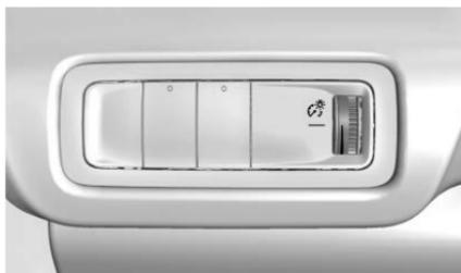
Cette fonction permet d'ajuster la luminosité de toutes les commandes éclairées. L'éclairage du tableau de bord se trouve à côté de la commande de feux extérieurs.
