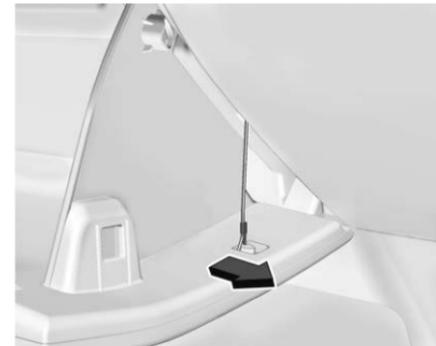
3. Décrocher l'amortisseur à corde pour retirer complètement le bac de la boîte à gants.
