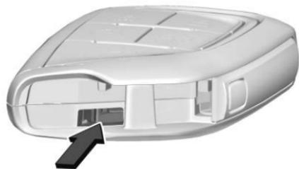
2. Utiliser la lame de la clé mécanique dans la fente pour retirer le couvercle de la pile à la main.
