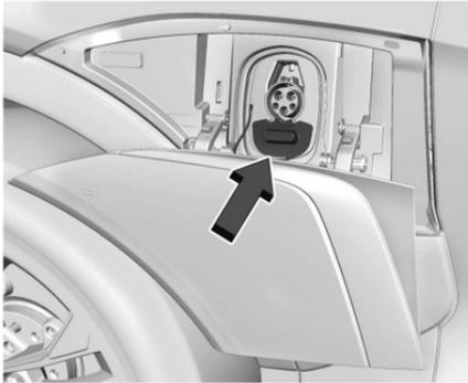
3. Déverrouiller le couvercle anti-poussière de charge en courant continu et l'abaisser complètement.
