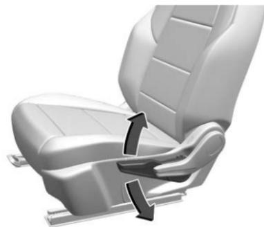
Selon l'équipement, déplacer le levier vers le haut ou vers le bas pour monter ou descendre manuellement le siège.
