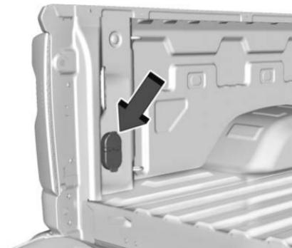
Si le véhicule est équipé de l'ensemble de remorquage à sellette/col-de-cygne, le connecteur de câblage est fixé à l'intérieur du plateau de la camionnette, derrière la roue arrière.
