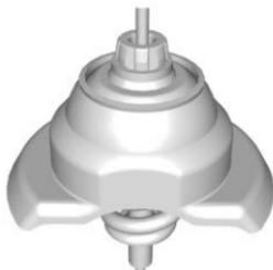
Pencher la retenue et la tirer au-travers du centre de la roue ensemble avec le câble et le ressort.
