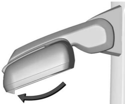
Selon l'équipement, saisir fermement le boîtier de rétroviseur et titrer d'un coup dans un mouvement circulaire vers l'arrière du véhicule.
