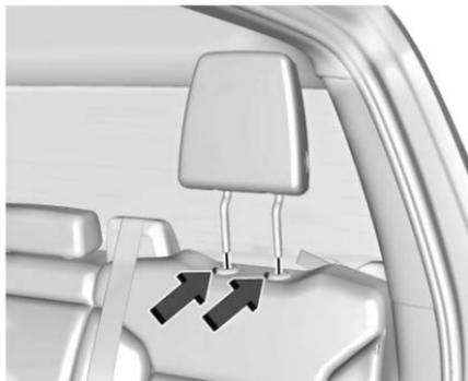
1. Appuyer simultanément sur les deux boutons des tiges d'appui-tête ou de repose-tête, puis le tirer vers le haut.
