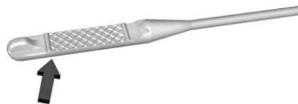
Si le niveau d'huile se situe au-dessous de la section quadrillée de la pointe de la jauge et que le moteur est éteint depuis au moins 15 minutes, ajouter 1 litre d'huile (1 pt) préconisée et vérifier encore le niveau. Se reporter à « Choix de l'huile moteur appropriée » plus loin dans cette section pour obtenir des explications sur le type d'huile à utiliser. Pour la capacité d'huile moteur du carter, se reporter à *Capacités et spécifications* ⇨ 494.
