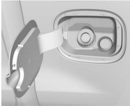
Le système de remplissage de carburant sans bouchon est dépourvu de bouchon de réservoir. Insérer et verrouiller complètement le bec de remplissage, commencer à remplir le réservoir.
