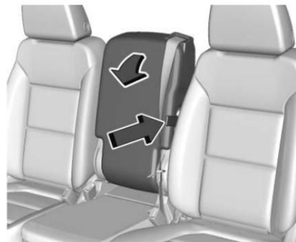
Tirer la sangle sur le côté du dossier de siège central pour le rabattre. Ne pas utiliser le dossier du siège central pour s'asseoir lorsque le dossier de siège est rabattu.
