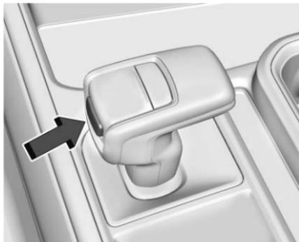
Ce véhicule est équipé d'une transmission à commande électronique. Le bouton de déblocage du verrouillage de vitesses est conçu pour éviter que le véhicule quitte la position P (stationnement), à moins que le contact soit mis, que la pédale de frein soit enfoncée, et que le bouton de déblocage du verrouillage de vitesses soit enfoncé.
