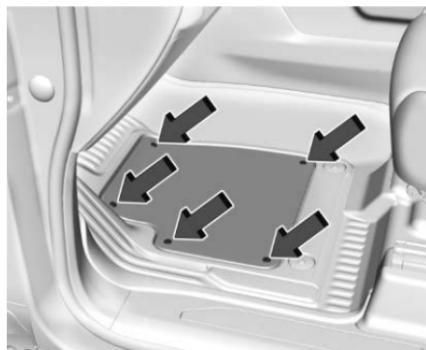
Réinstaller en alignant les clips du bouton d'insert du revêtement de sol sur les fixations du revêtement et en les enclenchant en position.
