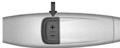
Le mode de sélection de gamme permet de contrôler la boîte de vitesses et la vitesse du véhicule, en conduite en descente ou en tractant une remorque. Il permet la sélection manuelle d'une gamme de rapport voulue.
