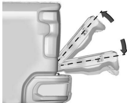
Pour fermer le hayon à l'aide de la fonction soulever pour fermer, soulever le hayon depuis la position complètement ouverte jusqu'à au moins 10 cm (4 po) et le maintenir momentanément. Ensuite, le hayon se ferme automatiquement. Si le hayon est soulevé au-delà de mi-parcours entre l'ouverture et la fermeture, il ne se ferme pas automatiquement.
