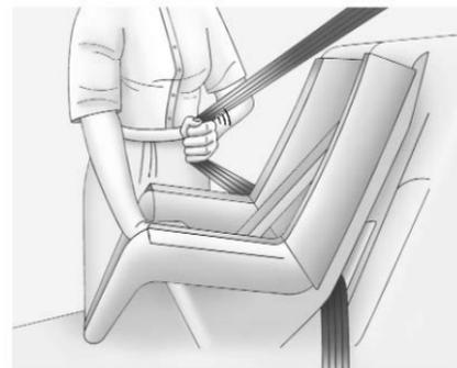
5. Tirer complètement la ceinture épaulière de l'enrouleur pour engager le système de blocage. Lorsque le verrou de l'enrouleur est activé, la ceinture peut être serrée mais pas tirée hors de l'enrouleur.
