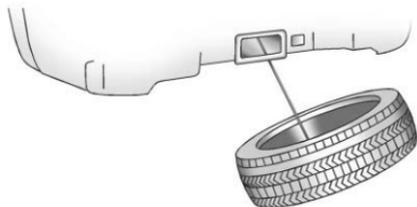
7. Pencher le pneu vers le véhicule avec un relâchement dans le câble afin d'accéder à la retenue de pneu/roue.
