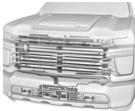
Le véhicule peut être équipé d'un système d'obturation conçu pour aider à améliorer l'économie de carburant. Garder le système d'obturation à l'écart des débris, de la neige et de la glace. Si le témoin de contrôle du
