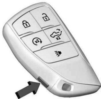
Si le véhicule est équipé d'un système d'accès sans clé, la clé télécommande comporte un bouton sur le côté de la clé télécommande pour enlever la clé.
