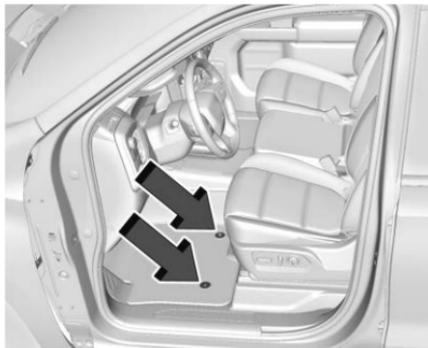
Réinstaller le tapis/revêtement de sol en plaçant les orifices sur les dispositifs de retenue et les emboîter en place.
