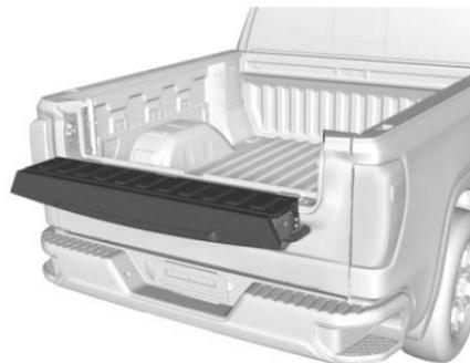
Pour ouvrir le hayon intérieur, appuyer sur le pavé tactile supérieur de la poignée du hayon après avoir déverrouillé toutes les portes. Tirer le haut du hayon pour l'ouvrir.
