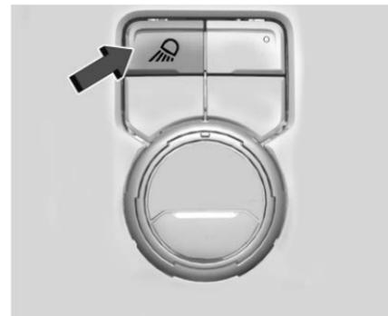
Selon l'équipement, l'éclairage localisé projette la lumière des rétroviseurs extérieurs hors du véhicule.
