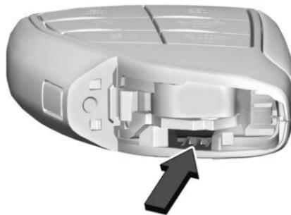
2. Utiliser la lame de la clé mécanique dans la fente pour retirer le couvercle de la pile à la main.
