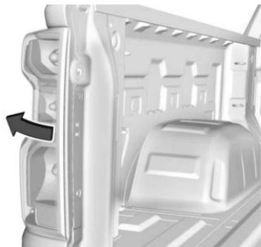
4. Tourner la douille de l'ampoule dans le sens contraire des aiguilles d'une montre.
