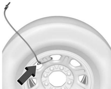
9. Si le véhicule est équipé d'un câble de roue de secours, le retirer de la roue de secours en passant le clip au travers de la boucle du câble.
