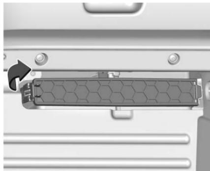
4. Tirer le levier sur le côté gauche de la trappe du filtre et glisser à gauche, puis déposer la porte. Déposer le filtre usagé.
