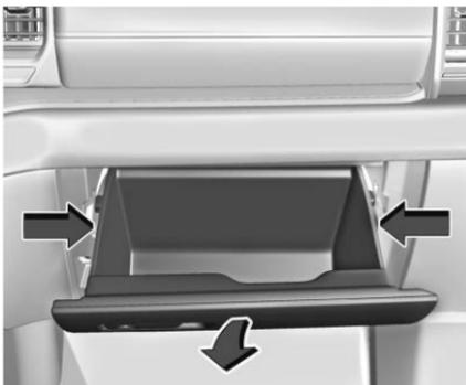
3. Appuyer les côtés de la trappe de la boîte à gants vers l'intérieur et tourner la trappe vers le bas pour la retirer.
