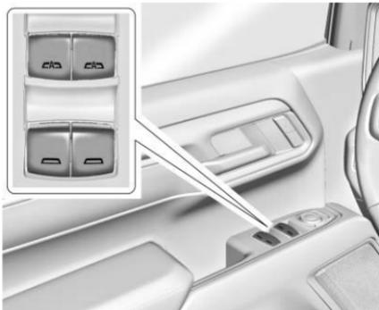
Les lève-vitres électriques fonctionnent lorsque le véhicule est en marche, en mode accessoires ou lorsque la prolongation de l'alimentation des accessoires (RAP) est active. Se reporter à *Prolongation d'alimentation des accessoires* ⇨ 247.
