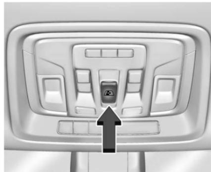
Selon l'équipement, les glaces arrière coulissantes électriques fonctionnent lorsque le contact est allumé ou en mode accessoires, ou la prolongation de l'alimentation des accessoires (RAP) doit être active. Se reporter à *Prolongation d'alimentation des accessoires* ⇨ 247.
