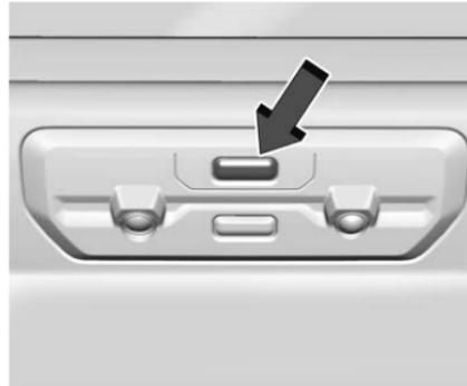
Le hayon intérieur MultiFlex peut être équipé d'une fonction d'activation/désactivation pour empêcher l'ouverture du hayon intérieur lorsqu'un attelage ou un autre équipement est installé et risque d'endommager le hayon intérieur.
