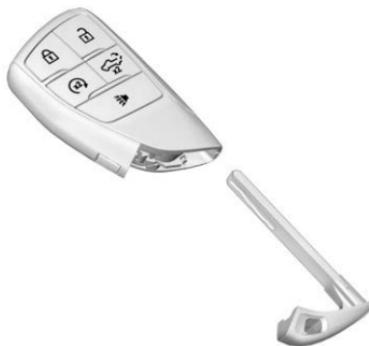
Appuyer sur le bouton pour retirer la clé. Ne jamais retirer la clé sans appuyer sur le bouton.
