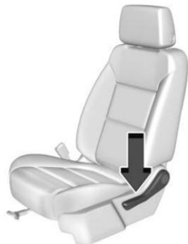
Pour régler un dossier de siège à commande manuelle :
