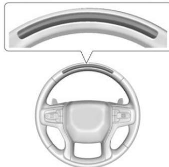
La barre lumineuse au volant et le témoin lumineux du groupe d'instruments fournissent des informations importantes relatives au fonctionnement de Super Cruise, qui sont les suivantes :
