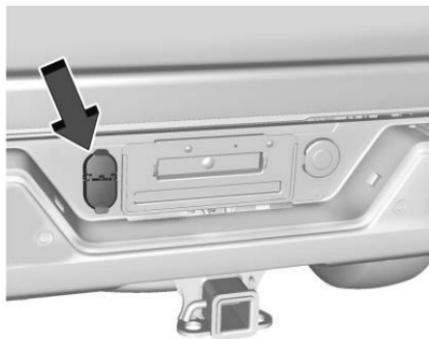
Selon l'équipement, le faisceau de câbles de la remorque, avec un connecteur à sept broches et un connecteur à quatre broches, est monté sur le pare-chocs arrière du véhicule.
