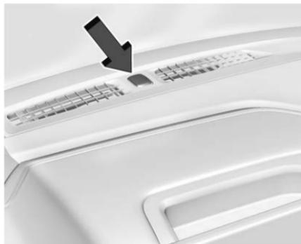
La sonde d'ensoleillement, sur le haut du tableau de bord près du pare-brise, surveille l'intensité du rayonnement solaire.
