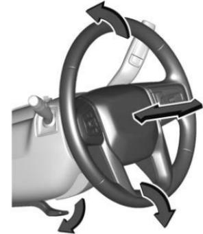
Pour régler le volant inclinable et télescopique, selon l'équipement :
