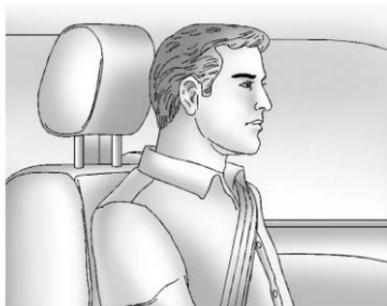
Régler l'appui-tête de sorte que sa partie supérieure arrive au niveau du haut de la tête de l'occupant. Cette position réduit les risques de blessure à la nuque lors d'une collision.
