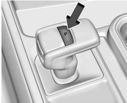
**P** : Cette position verrouille les roues arrière. Utiliser P (Park) lors du démarrage du moteur pour éviter que le véhicule ne se déplace facilement.
