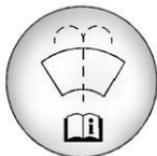
Enlever le bouchon marqué du symbole de lave-glace. Ajouter du liquide jusqu'à ce que le réservoir soit plein. Se reporter à *Aperçu du compartiment moteur* ↪ 390 pour connaître l'emplacement du réservoir.
