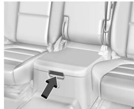
Si le véhicule est équipé d'un rangement de siège central avant, déverrouiller avec la clé mécanique de la clé de télécommande, appuyer sur le loquet et soulever pour ouvrir.
