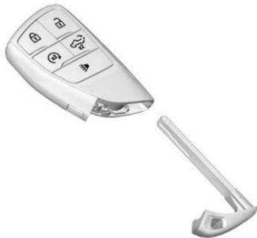
1. Appuyer sur le bouton sur le côté de la clé-télécommande près de la base et extraire la clé mécanique. Ne jamais retirer la clé mécanique sans appuyer sur le bouton.
