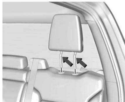
1. Insérer les montants de l'appui-tête ou du repose-tête dans les trous en haut du dossier de siège. Les encoches sur les montants doivent être orientées vers le côté conducteur du véhicule.
