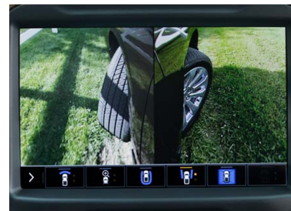
Vue du côté avant Affiche la position des pneus avant lors du stationnement et des manœuvres serrées.
