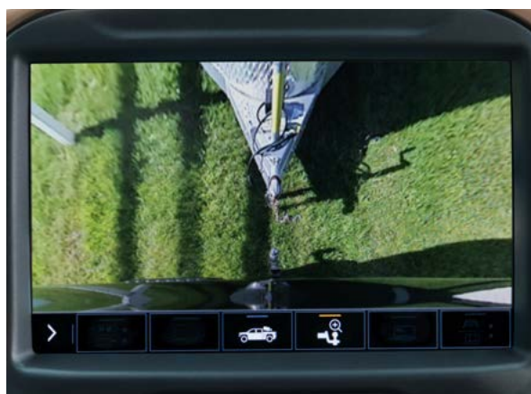
Vue de l'attelage Permet d'avoir une vue rapprochée de l'attelage pour faciliter l'alignement lors de la connexion à une remorque.
