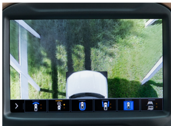
Vue verticale avant Une vue verticale du capot, du pare-chocs et des pneus avant pour faciliter les manœuvres serrées dans les stationnements ou près des trottoirs.
