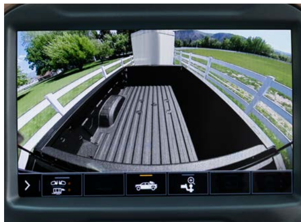
Vue de la remorque Permet de voir à l'intérieur de la caisse pour faciliter l'attelage de la sellette ou du col de cygne et pour surveiller brièvement le chargement.
