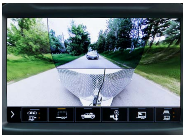
Vue de remorque transparente Permet au conducteur de voir virtuellement « à travers » une caisse ou une tente-caravane conventionnelle à attelage classique. Cette vue peut rester affichée lorsque le véhicule est en mouvement.
