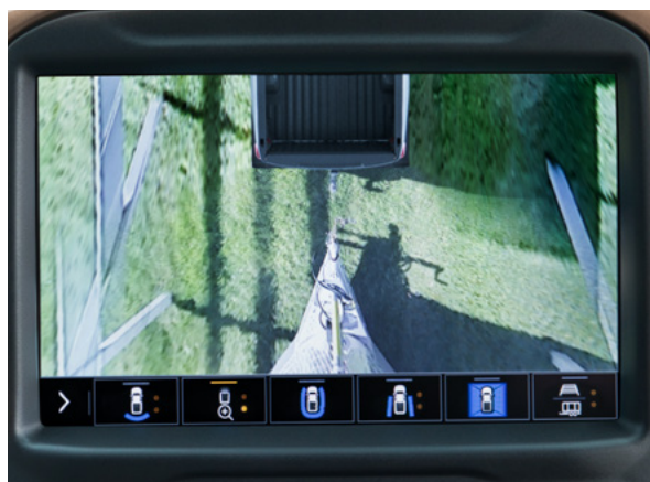
Vue verticale arrière Montre le dégagement entre la caisse du camion et les objets à proximité.
