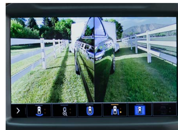
Vue latérale arrière Affiche la ligne de vision le long de chaque côté du camion et de la remorque. Cette vue peut rester affichée lorsque le véhicule est en mouvement.
